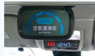
車内の空気清浄状況をセンサーを用いてモニタリングし、結果をタブレット端末に表示。車内の空気の「見える化」を実現。
