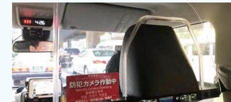
ドライバーへの危害防止のため、タクシー車両には、後部座席と運転席の仕切りとなる透明な「防犯プロテクター」や大音量を発する防犯サイレンなど、ドライバーの安全を守る設備の設置が進んでいます。
